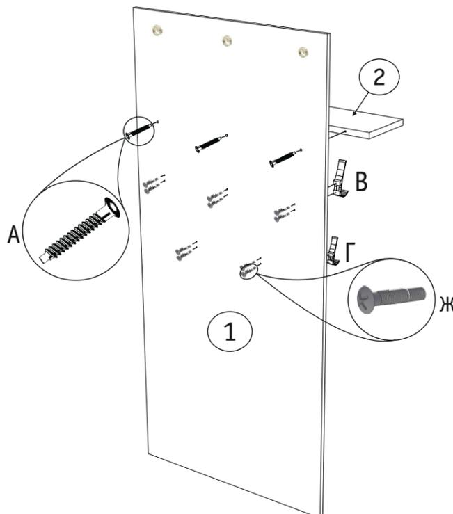
Рис. 1. Сборка вешалки.
