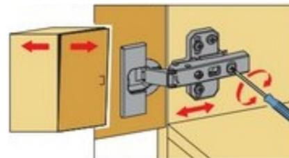
Прямая, бесступенчатая регулировка по глубине с помощью эксцентрикового винта.
