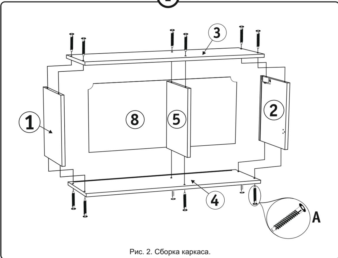
Рис. 2. Сборка каркаса.
