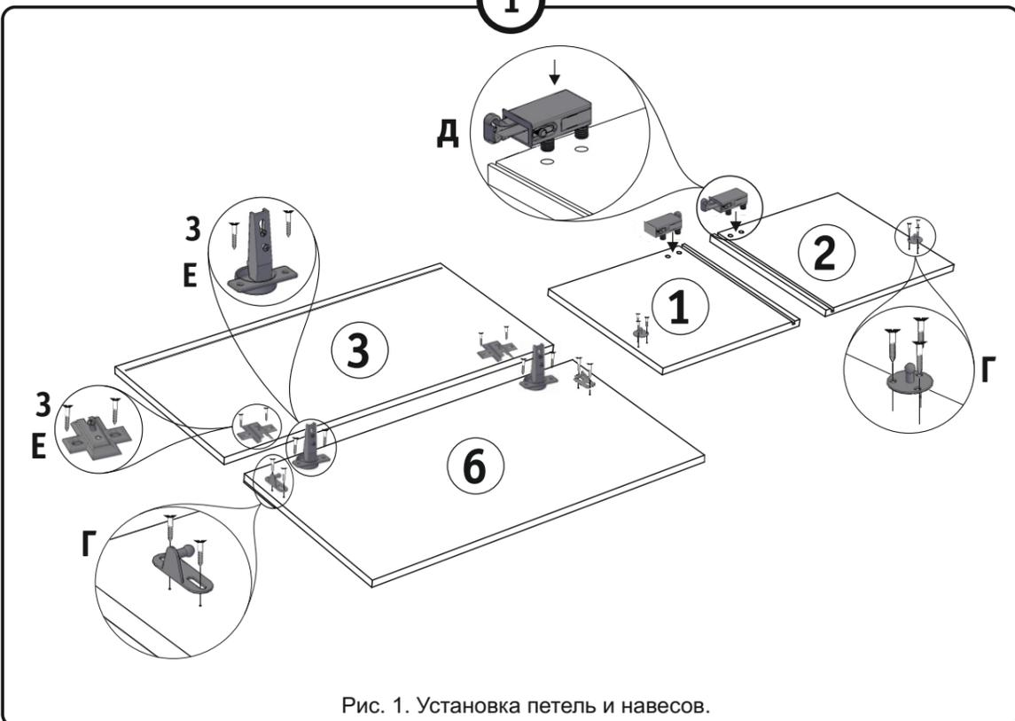
Рис. 1. Установка петель и навесов.
