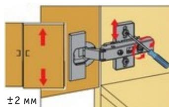
Двери можно точно выверить по высоте с помощью монтажных планок, регулируемых по высоте.
