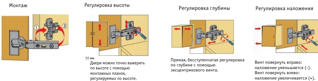
Рис. 7. Регулировка фасада.
