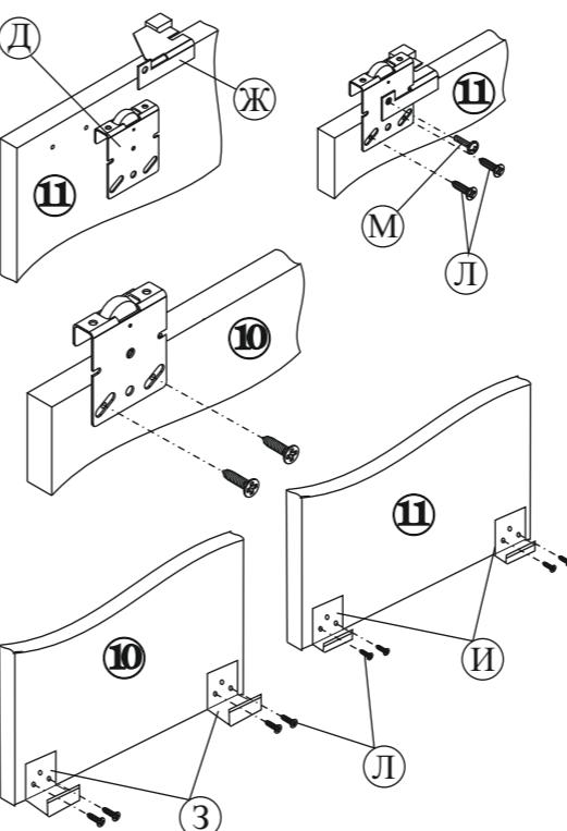
3.8. На двери (дет.№10,11) установите ходовые ролики (поз.Д) и стопор (поз.Ж) **на внутреннюю дверь** (дет.№11). Причем стопор ставится на ролик находящийся ближе к боковине шкафа, а амортизатор стопора направлен к центру шкафа. Для крепления стопора к ролику используйте винт (поз.М). На внешнюю дверь (дет.№10) устанавливаются ролики без стопора.
