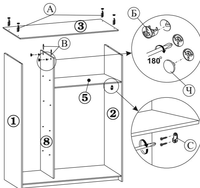
3.6. В крышку (дет.№3) вкрутите два штока эксцентрика (поз.В). Затем установите крышку на каркас шкафа, закрепив ее винтовыми стяжками с боками (дет. №1 и №2) и установив эксцентрики (поз.Б) в перегородку (дет.№8) поверните их на 180 градусов по часовой стрелке. На деталях №2 и №8, под полкой (дет.№8), шурупами закрепите штангодержатели (поз.С). Установите штангу (поз.T).
