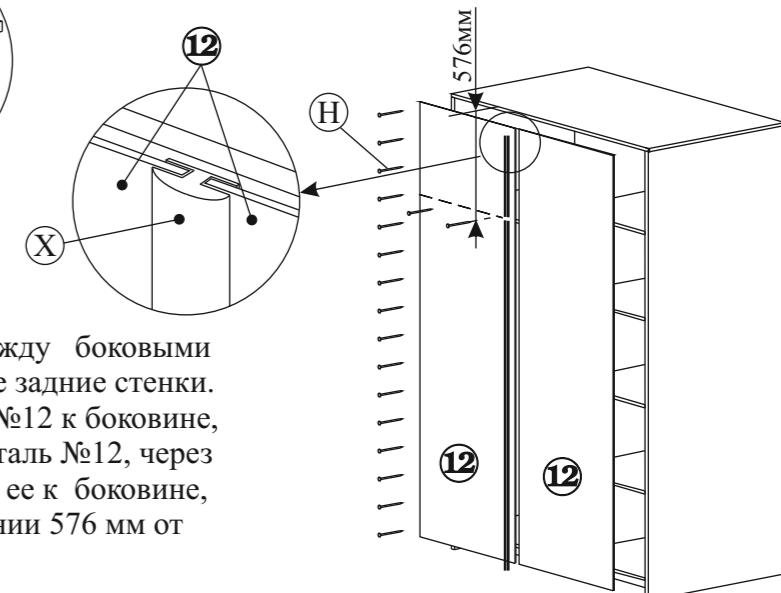
3.7. Выровняйте шкаф так, чтобы между боковыми стенками и дном был прямой угол. Установите задние стенки. Для этого: Закрепите гвоздями (поз.Н) Деталь №12 к боковине, дну и крышке. Затем присоедините вторую деталь №12, через стыковочный профиль (поз.Х), и закрепите ее к боковине, дну и крышке. И к полке (дет.№5) на расстоянии 576 мм от верхней плоскости крышки (дет.№3).
