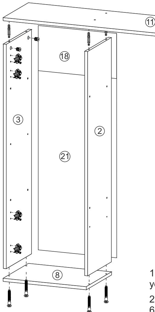
Монтаж эксцентриковой стяжки
