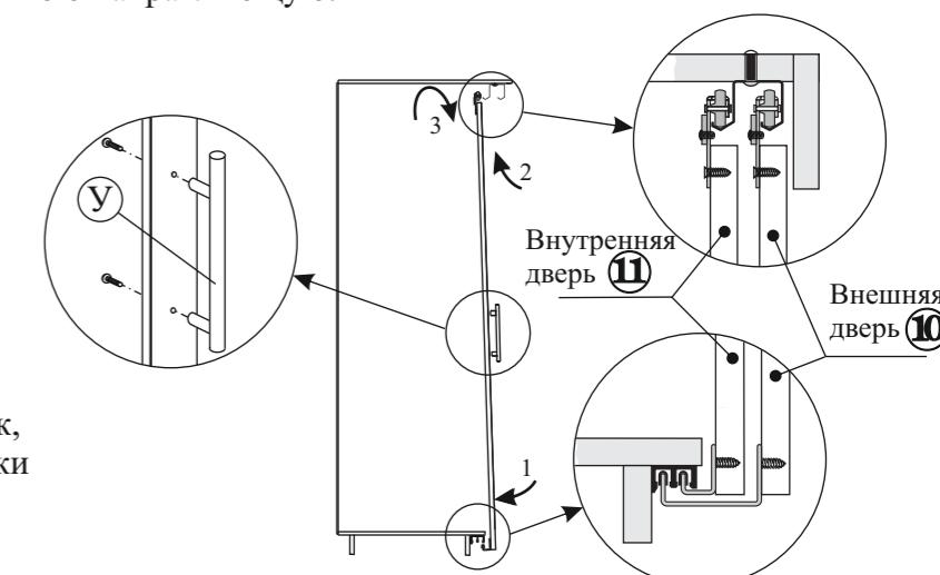
3.10. Установите планку (дет.№9), закрепив ее винтовой стяжкой (поз.А). Установите ручки (поз.У).
