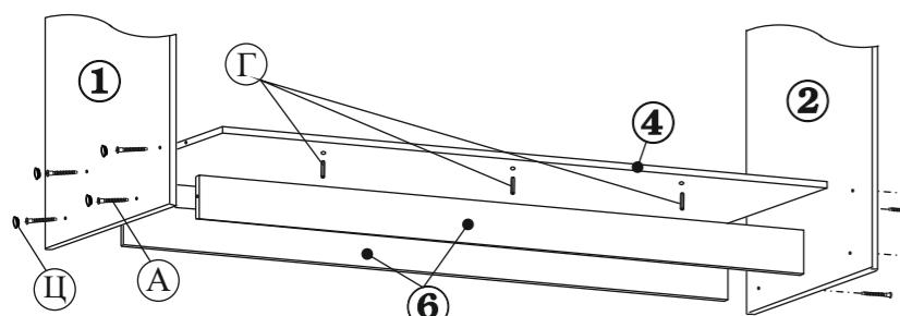
3.4. В дно (дет.№ 4) вкрутите штоки эксцентриков (позВ). Установите перегородку так, чтобы штоки эксцентриков вошли в торцевые отверстия перегородки. Установите эксцентрики (поз.Б), в отверстия в нижней части перегородки (дет.№8) стрелкой вниз. Затяните эксцентрики повернув их на 180 градусов по часовой стрелке.
