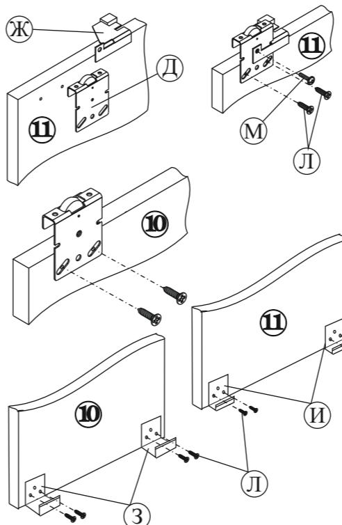
3.8. На двери (дет.№10,11) установите ходовые ролики (поз.Д) и стопор (поз.Ж) **на внутреннюю дверь** (дет.№11). Причем стопор ставится на ролик находящийся ближе к боковине шкафа, а амортизатор стопора направлен к центру шкафа. Для крепления стопора к ролику используйте винт (поз.М). На внешнюю дверь (дет.№10) устанавливаются ролики без стопора.
