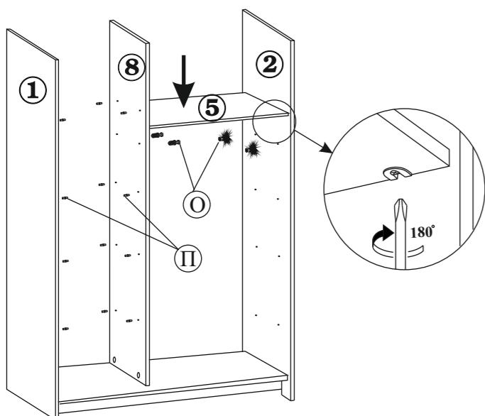
3.5. В детали № 2 и №8, вкрутите дюбели ввинчиваемые (поз. О). Установите на них полку (дет.№5). Зафиксируйте ее повернув винты вмонтированных в полку эксцентриков по часовой стрелке на 180 градусов. В детали №1 и №8, установите полкодержатели (поз.П).
