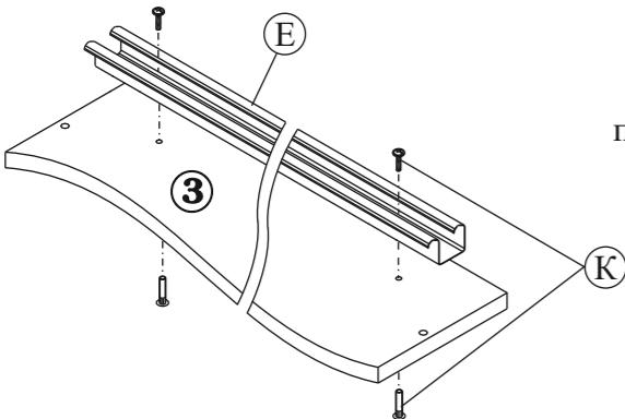
3.1. При помощи межсекционной стяжки (поз.К), закрепите на крышки (дет.№3) верхний ходовой профиль (поз Е).
