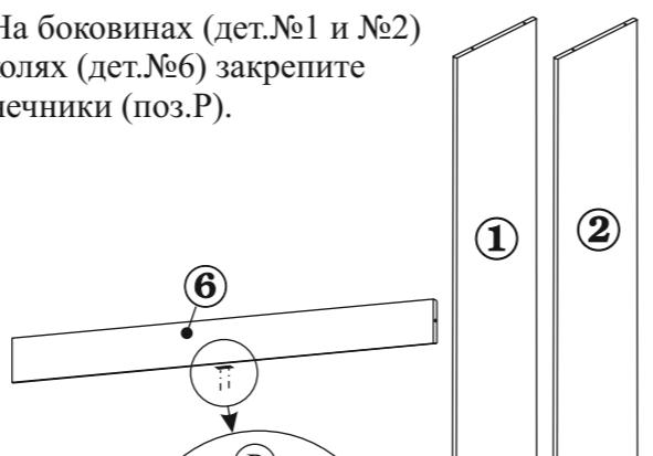
3.3. При помощи шкантов (поз.Г). Соедините цоколя (дет.№6) и дно (дет.№4). К полученной конструкции присоедините боковины (дет.№№ 1и2), закрепив их винтовой стяжкой (поз.А).
