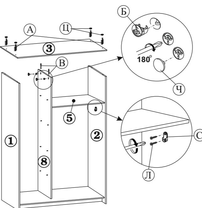
3.6. В крышку (дет.№3) вкрутите два штока эксцентрика (поз.В). Затем установите крышку на каркас шкафа, закрепив ее винтовыми стяжками с боками (дет. №1 и №2) и установив эксцентрики (поз.Б) в перегородку (дет.№8) поверните их на 180 градусов по часовой стрелке. На деталях №2 и №8, под полкой (дет.№8), шурупами закрепите штангодержатели (поз.С). Установите штангу (поз.T).
