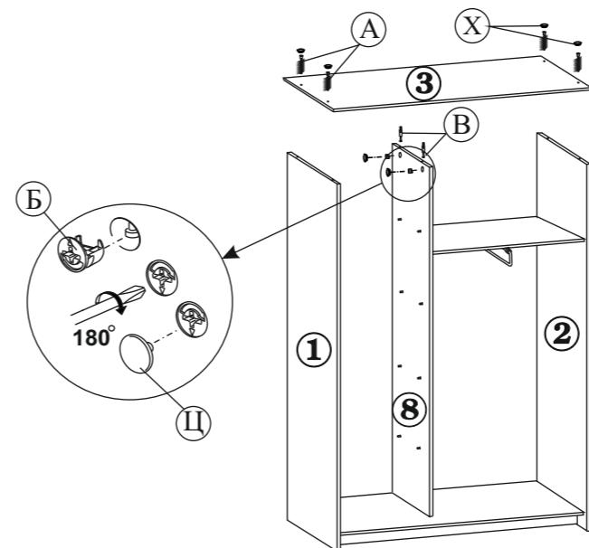
3.6. В крышку (дет.№3) вкрутите два штока эксцентрика (поз.В). Затем установите крышку на каркас шкафа, закрепив ее винтовыми стяжками с боками (дет. №1 и №2) и установив эксцентрики (поз.Б) в перегородку (дет.№8) поверните их на 180 градусов по часовой стрелке.
