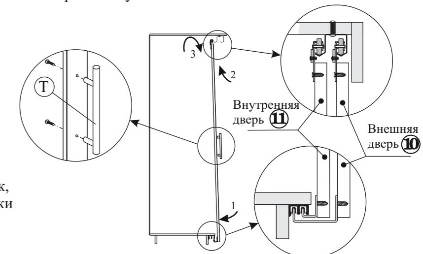
3.10. Установите планку (дет.№9), закрепив ее винтовой стяжкой (поз.А). Установите ручки (поз.Т).
