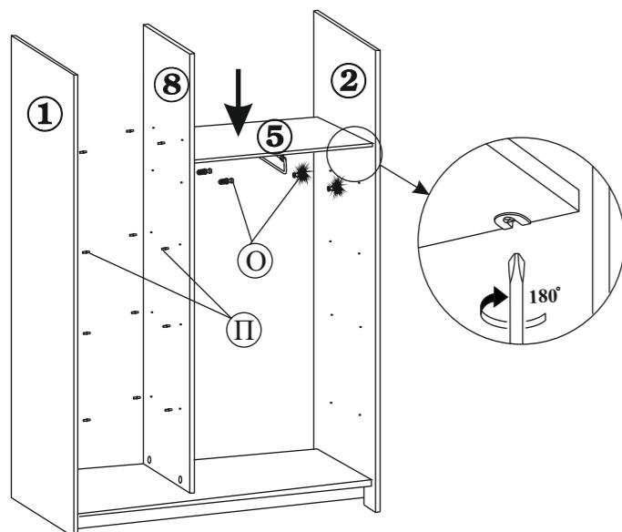
3.5. На детали №5, закрепите выдвижную штангу. В детали № 2 и №8, вкрутите дюбели ввинчивающиеся (поз. О). Установите на них полку (дет.№5). Зафиксируйте ее повернув винты вмонтированных в полку эксцентриков по часовой стрелке на 180 градусов. В детали №1 и №8, установите полкодержатели (поз.П).
