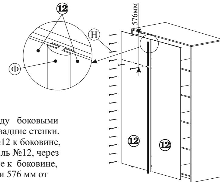
3.7. Выровняйте шкаф так, чтобы между боковыми стенками и дном был прямой угол. Установите задние стенки. Для этого: Закрепите гвоздями (поз.Н) Деталь №12 к боковине, дну и крышке. Затем присоедините вторую деталь №12, через стыковочный профиль (поз.Х), и закрепите ее к боковине, дну и крышке. И к полке (дет.№5) на расстоянии 576 мм от верхней плоскости крышки (дет.№3).
